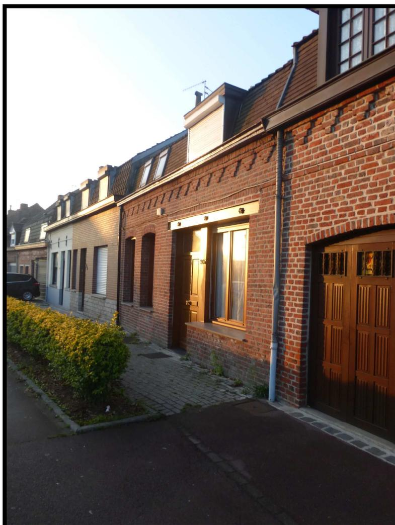
Il s'agit d'un immeuble dressé en maçonnerie de briques avec couverture tuiles et double mitoyenneté.
